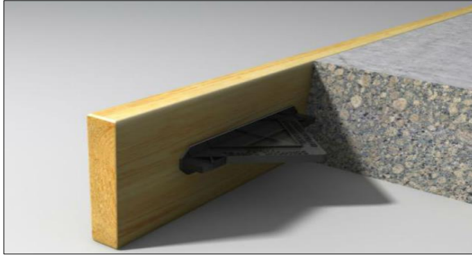
Figura N°14: Dowels en placas.
