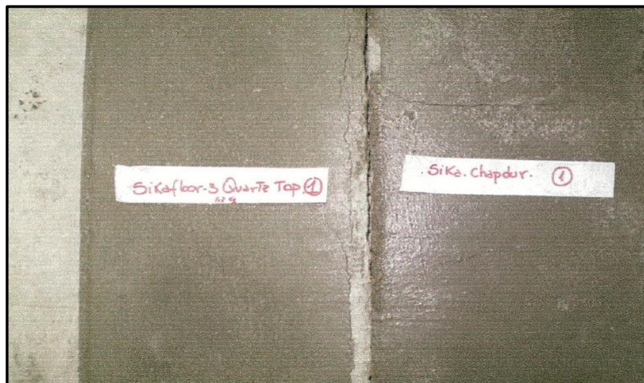
Figura N°22: Resultado de muestra con aplicación de endurecedor superficial expuesta a viento y calor.
