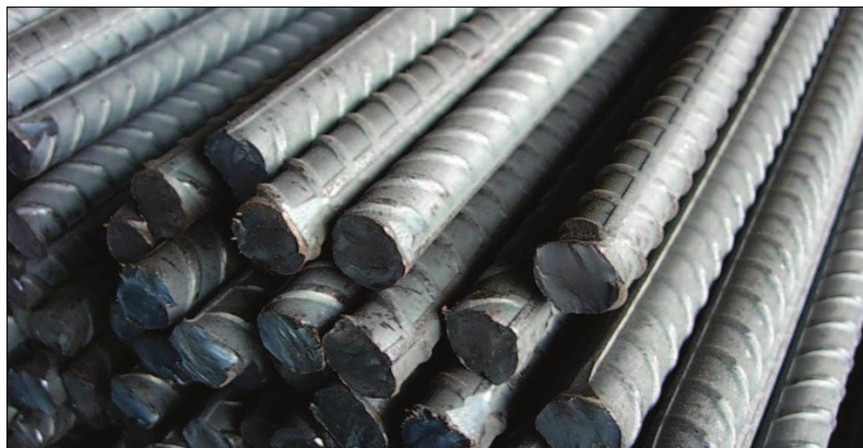
Figura N°12: Barras de acero corrugado
