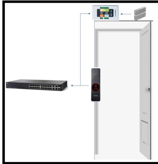
Figura N° 4: Sistema de control de acceso
