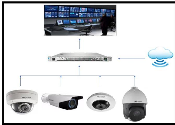
Figura N° 3: Esquema y equipos de CCTV
