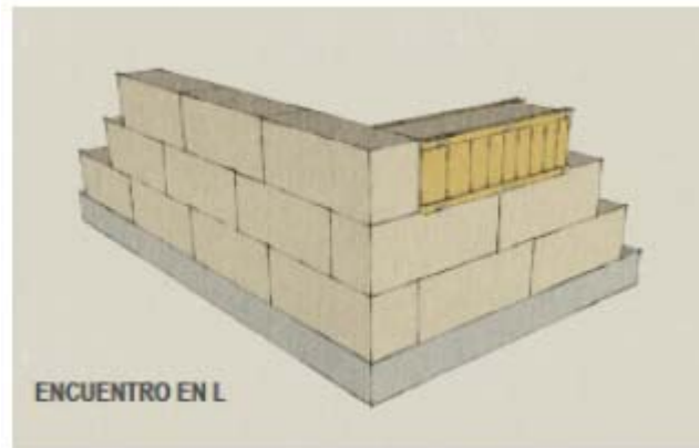
Imagen 6. Construcción de esquina en L. Seminario de Tapial en Tarma (2014).
