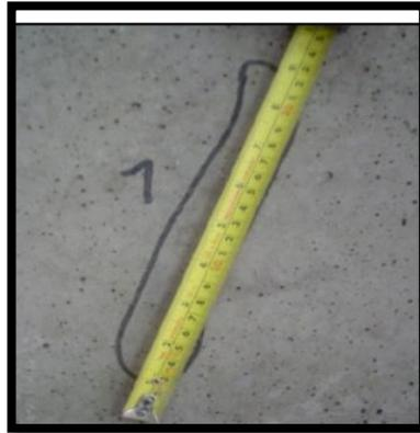
Foto 10: Medición de fisura
