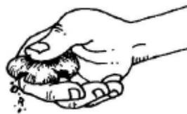
Si la bolita se rompe, la tierra **NO** sirve ya que no tiene suficiente arcilla y los adobes no serán resistentes.
