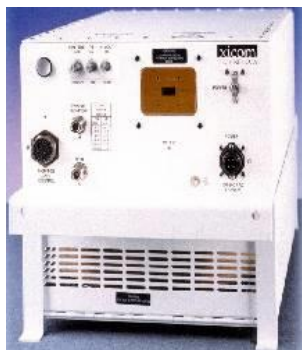
Figura 36: Amplificador HPA 1250W XICOM
