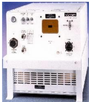
Figura 32: Amplificador HPA 750W XICOM
