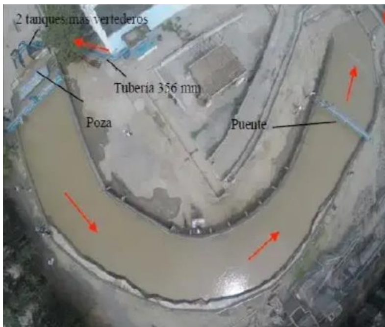
Modelo Físico del río Madre de Dios en el Laboratorio Nacional
