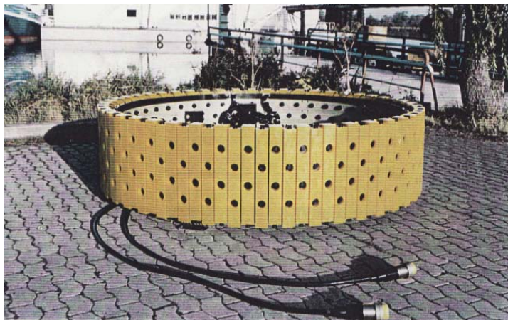
Fig. 5.1. Arreglo cilíndrico de hidrófonos.
