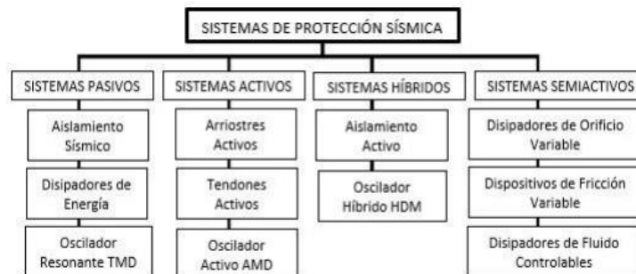
Figura N° 5: Clasificación de los Sistemas de Protección Sísmica
