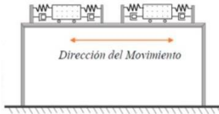
Figura N° 24: Amortiguadores de masa sintonizada múltiple
