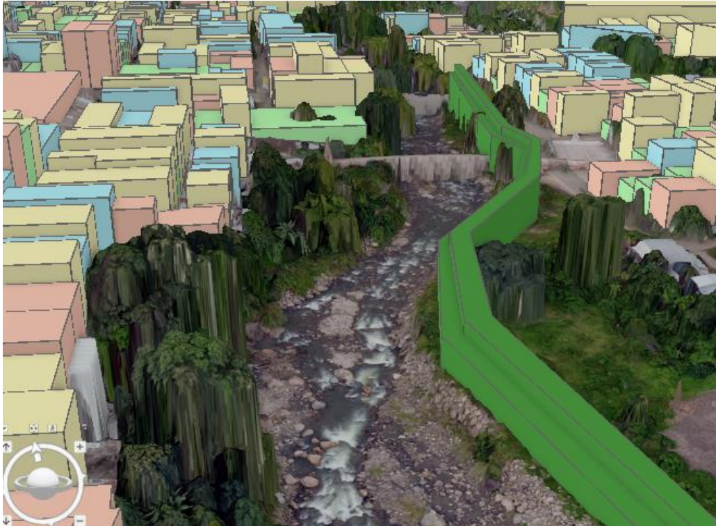
Figura 41: Vista del Río San Ramón en 3D con sus gaviones de altura de 5m en toda su longitud Fuente: Elaboración Propia
