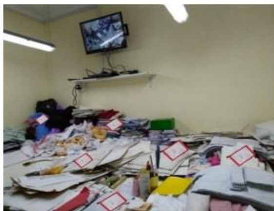
Figura 63. Aplicación de la tarjeta roja en la mesa de corte Fuente: MI PETITE E.I.R.L
