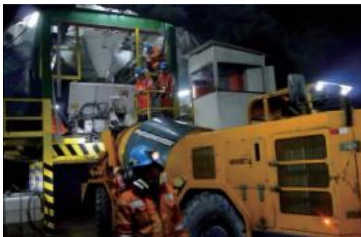
*Figura 03* Planta de concreto abasteciendo a transportador Mixkret 5- Interior Mina. Empresa
