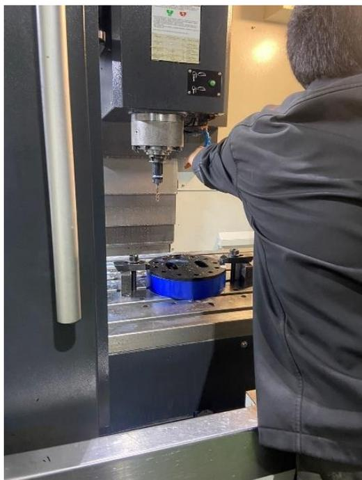
Figura 41 Mecanizado CNC de Instalador de Calibradores
