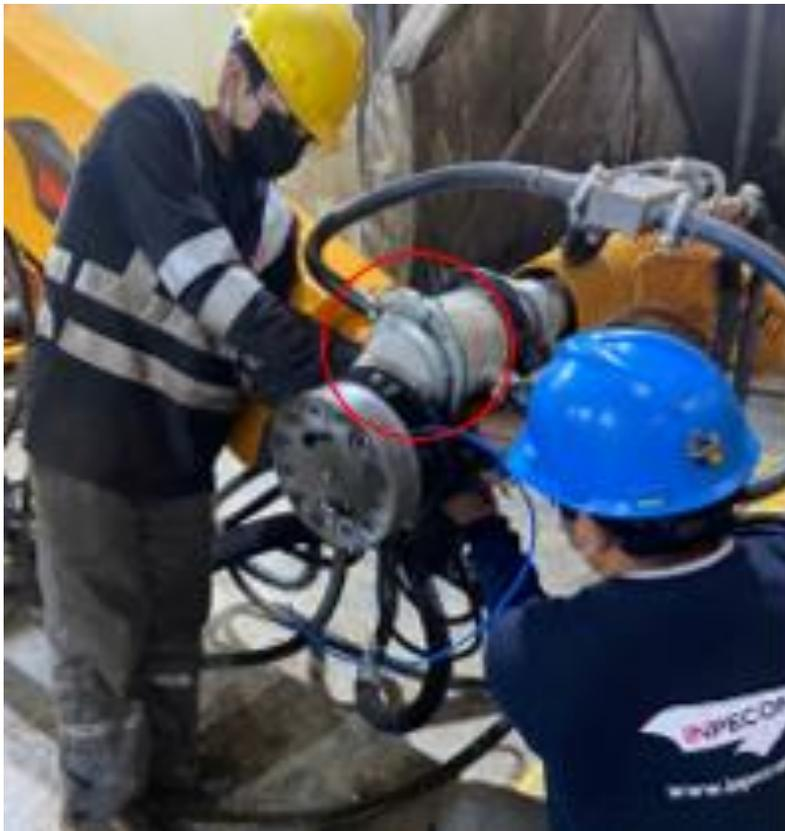
Figura 47 Instalador de Calibradores con Acoplamiento mecánico en Robot Lanzador de shotcrete Putzmeister 4210
