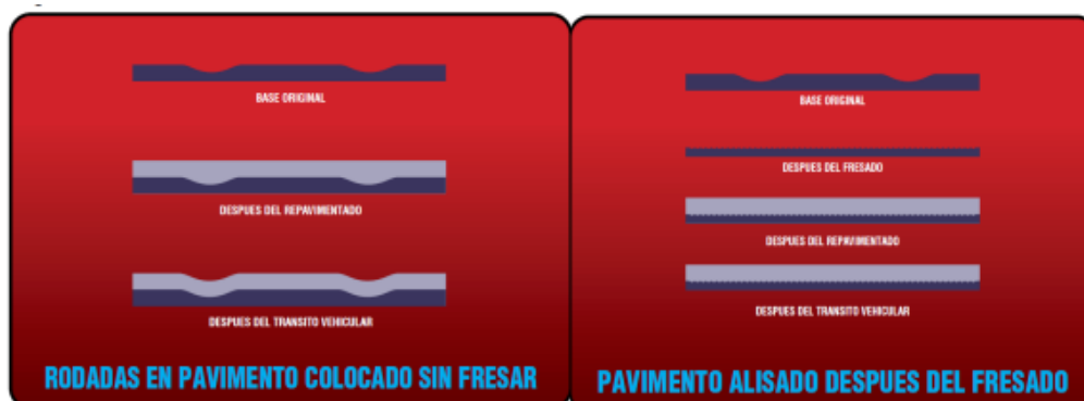
Figura N 29: Diferencia entre pavimento fresado y sin fresar
