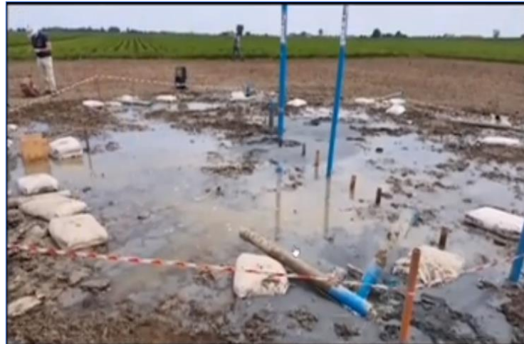
Figura 10. Licuación de suelos en Italia ensayo con explosivos. Fuente. (Geopier, 2020)
