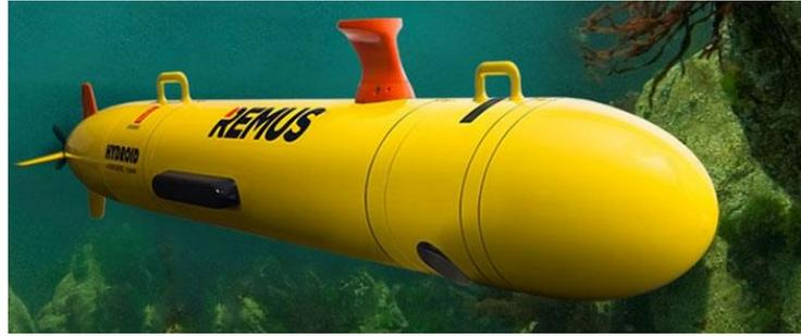
*Figura N 5:* Vehículo submarino autónomo
