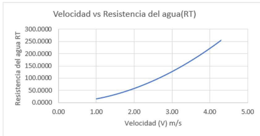
Figura N 64: Curva velocidad (V) vs Resistencia del agua (Rt)
