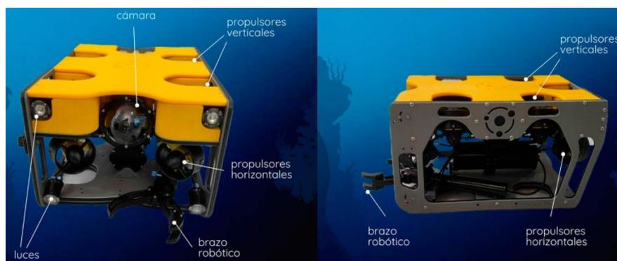
*Figura N 6:* Vehículo de operación remota (ROV)
