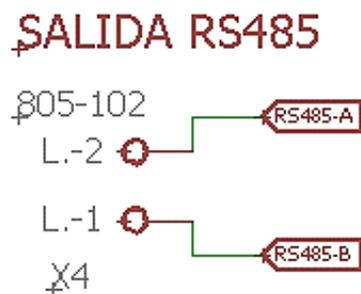
Figura N 57: Borneras para la comunicación RS-485
