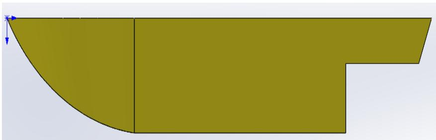
*Figura N 41:* Vista de perfil de casco
