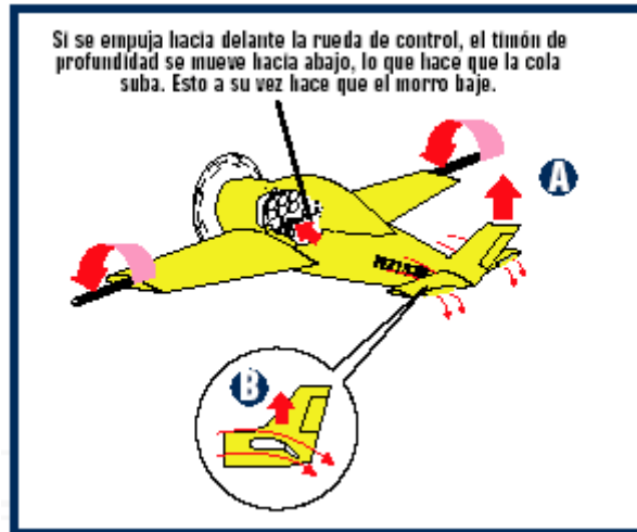
Figura 6 . Cómo el control del timón de profundidad cambia el cabeceo del avión
