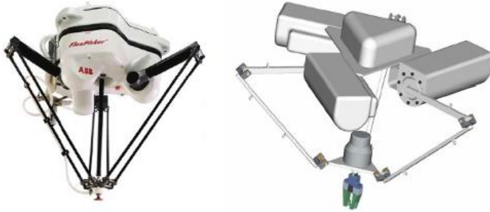
Figura 23. Robots paralelos de cuatro grados de libertad, basados en la plataforma Delta.
