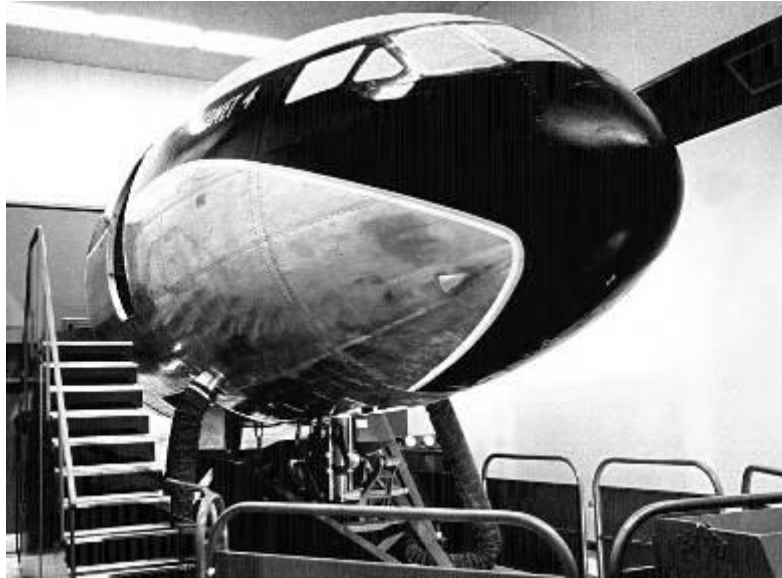
Figura 15. Simulador de avión BAC Comet, con sistema hidráulico de movimiento
