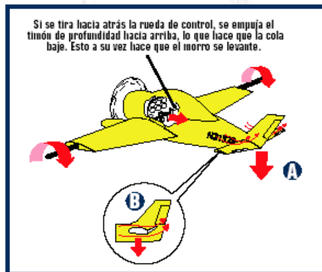
Figura 5 . Cómo el control del timón de profundidad cambia el cabeceo del avión
