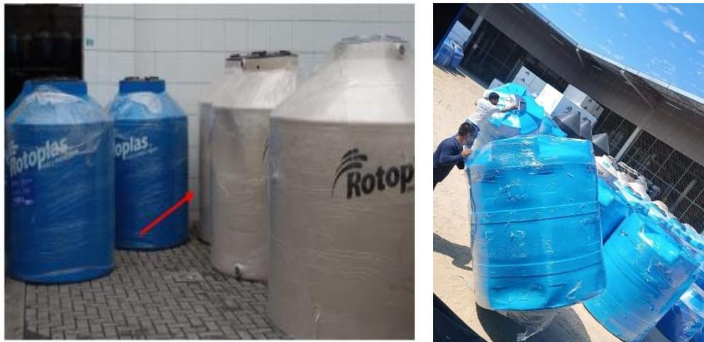
*Figura N°42. Tanques dañados en el proceso de descarga antes de la mejora*
