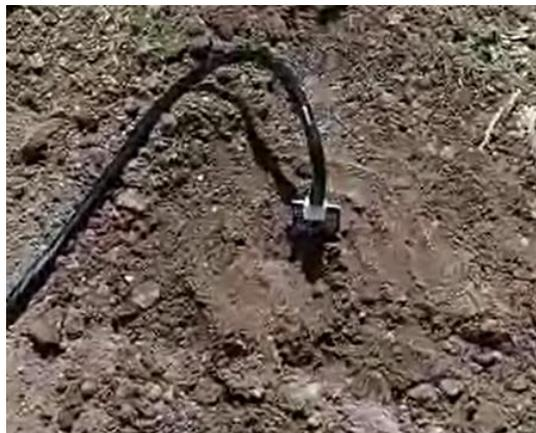
*Figura 35:* Sensor de humedad de suelo en terreno de prueba
