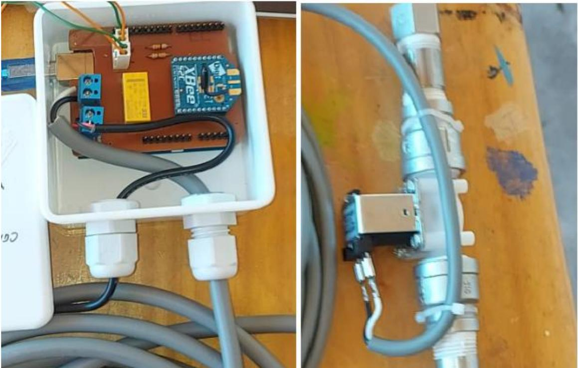
*Figura 36:* Nodo coordinador con válvula de riego
