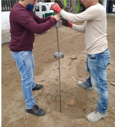
*Figura 12 – Realización de ensayo DCP*
