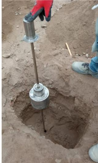
*Figura 14 – Realización de ensayo DCP*
