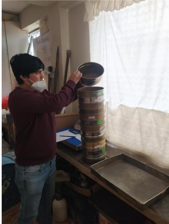
*Figura 16 – Realización de análisis granulométrico*
