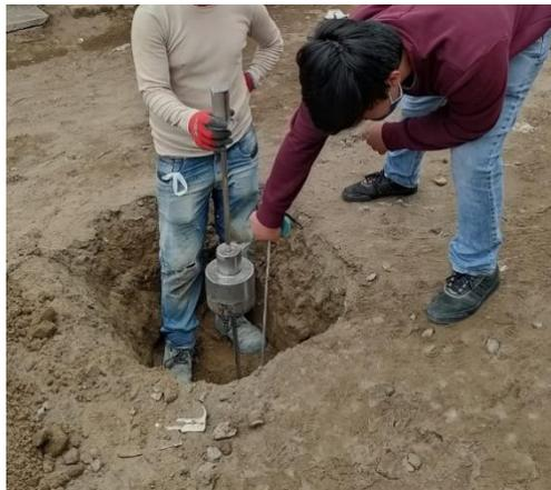
*Figura 13 – Medición en ensayo DCP*
