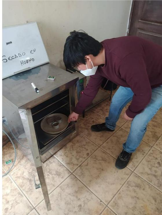
*Figura 15 – Realización de ensayo contenido de humedad*
