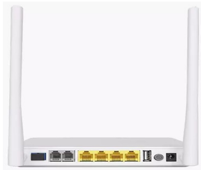
Figura 14. GPON hgu ONT Fuente: Cdatec.
