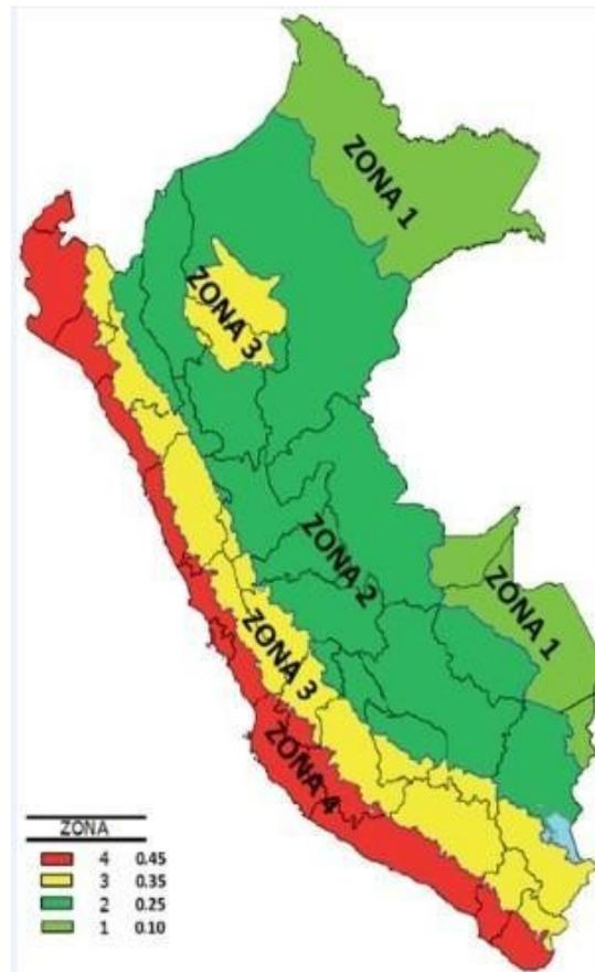
Figura N° 9 Zonificación del Peligro Sísmico en el Perú
