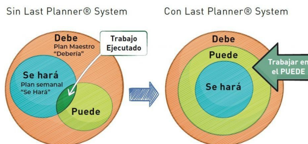
Figura 4. Proceso sin Las Planner Vs. Proceso con Last Planner Fuente: Colegio Oficial de Aparejadores y Arquitectos técnicos de Zaragoza
