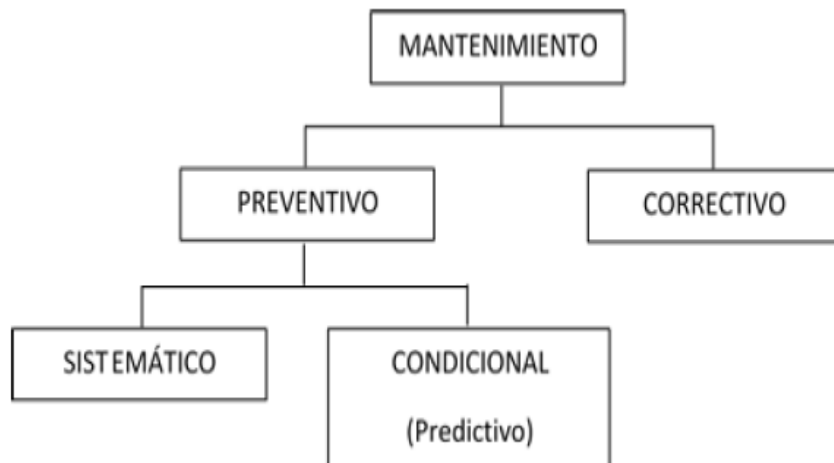
Figura 11. Niveles y tipos de mantenimiento Fuente: Técnicas de mantenimiento Industrial 2da edic. (2010)
