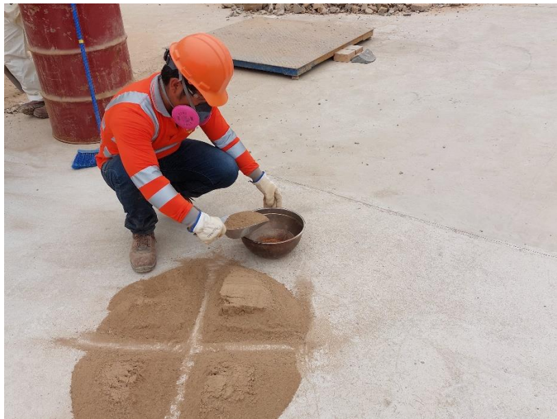
Figura N 20: Ensayo de determinación del contenido de humedad Fuente: Elaboración Propia.
