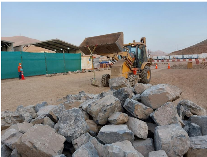
Figura N 23: Ensayo de macro-granulometría de Roca tipo III Fuente: Elaboración Propia.
