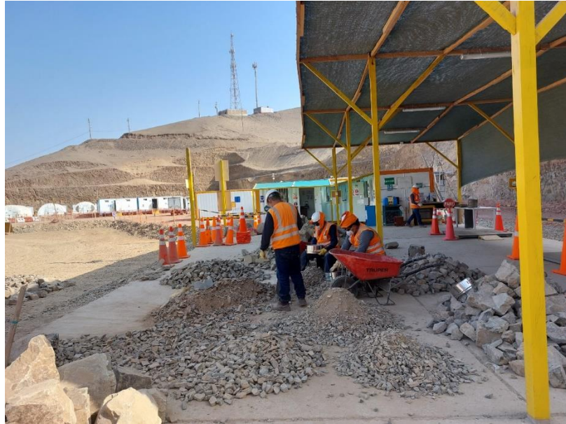
Figura N 19: Ensayo de Macro-granulometría para Quarry Run Fuente: Elaboración Propia.
