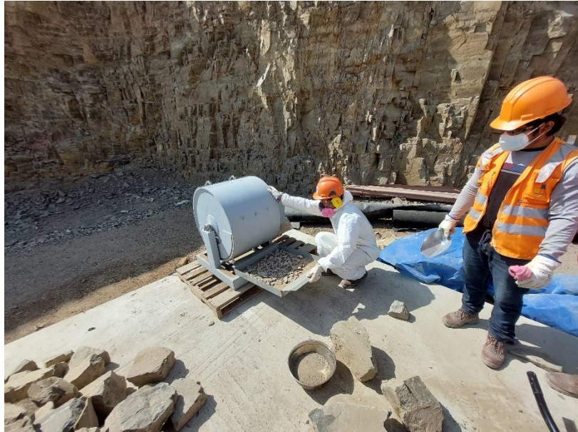
Figura N 22: Ensayo de resistencia a la degradación Fuente: Elaboración Propia.
