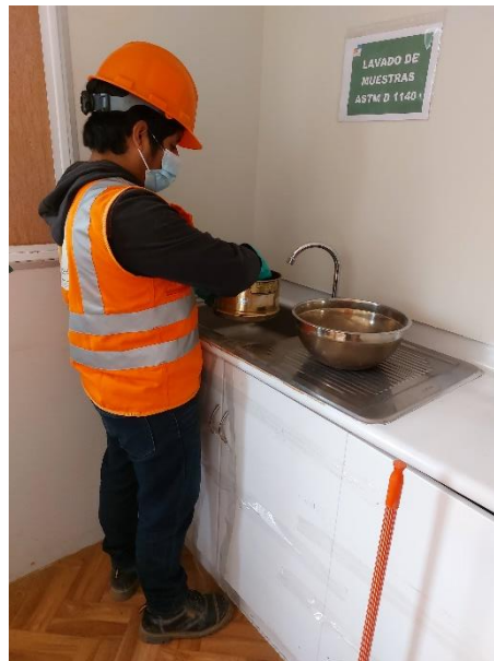
Figura N 21: Ensayo de determinación de la cantidad de material más fino que N°200 Fuente: Elaboración Propia.
