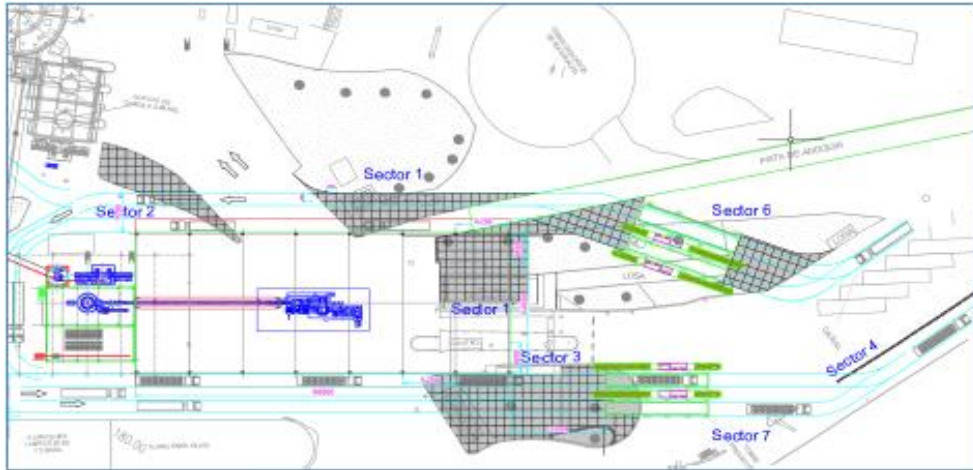
Figura N° 24. Plano de la obra, donde se muestran en gris los sitios donde se construirán los pavimentos rígidos.
