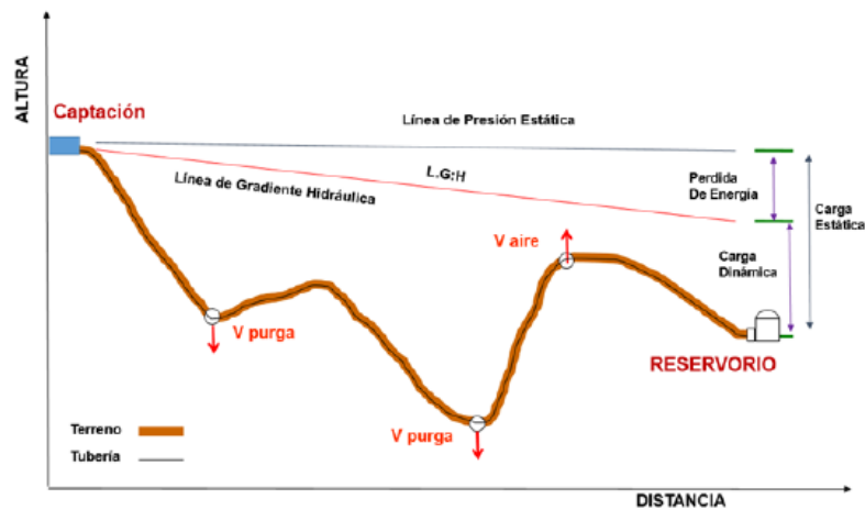
Figura N° 8: Línea de conducción. Fuente: (Llaza, 2016, pág. 10)
