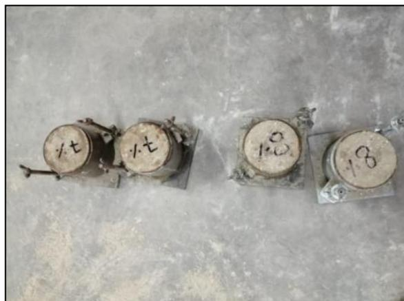
Figura 50. Probetas con 7% cemento y 8% cemento
