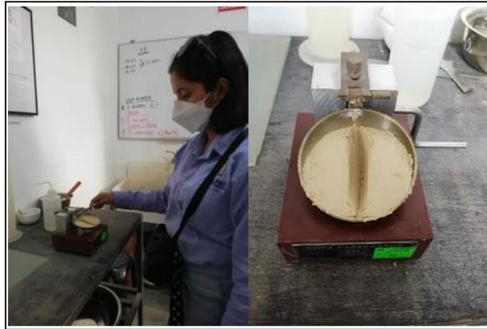
*Figura 36.* Ensayos de límite líquido
