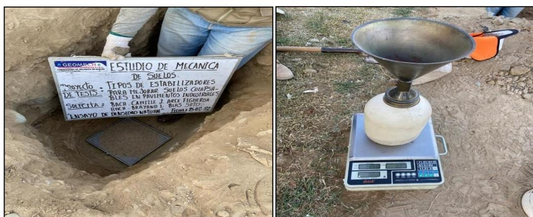
Figura 31. Ensayo de Cono de Arena a 1 metro de profundidad
