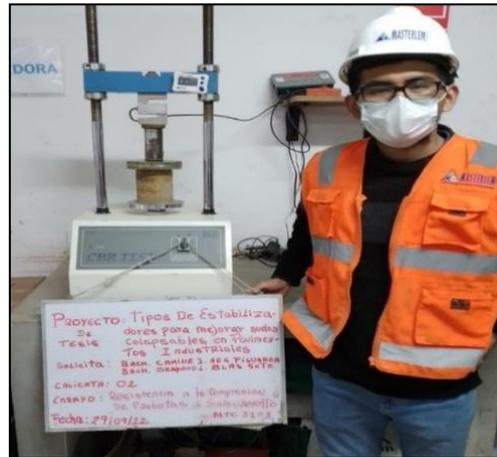
Figura 51. Ensayo de Compresión no confinada para briqueta Suelo Cemento
