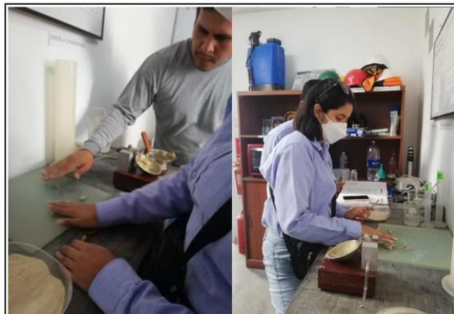
*Figura 37.* Ensayos de límite plástico
