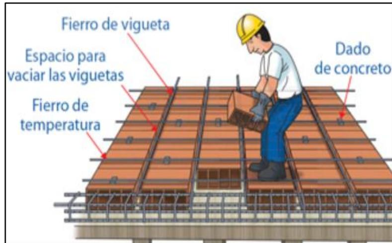
Figura N° 37: Losa aligerada de ladrillo
