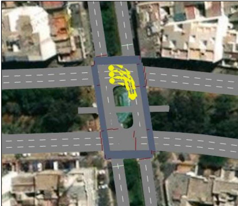
Figura 43 " Carriles conectores en el modelo Sur a Oeste"
