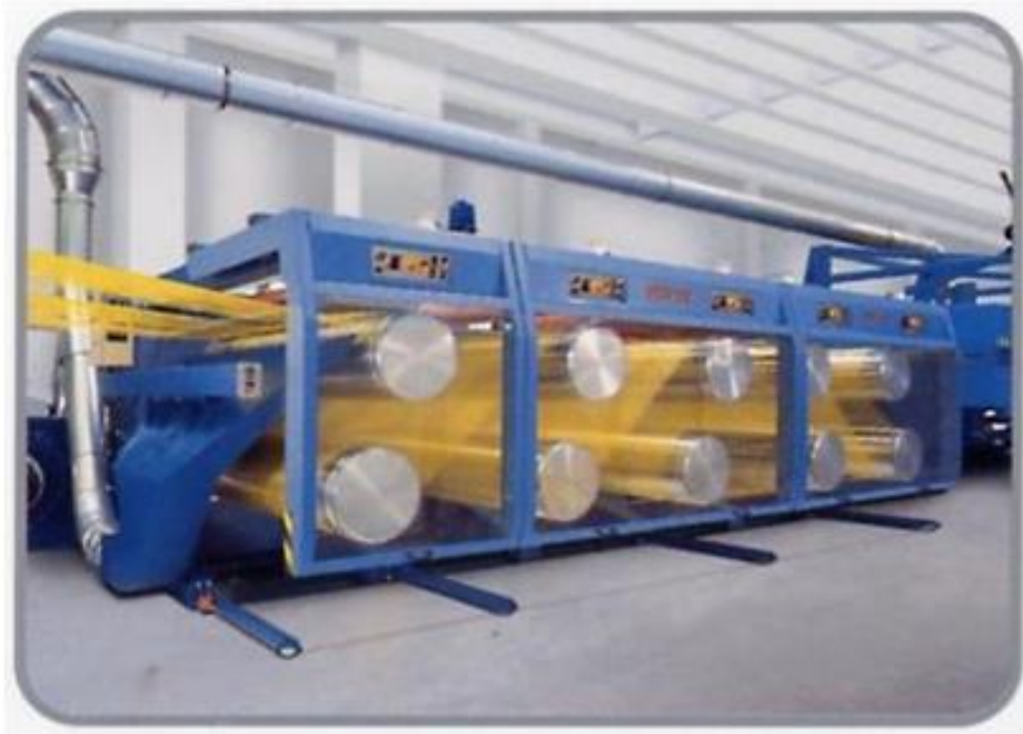
FIG. N° 13, ENCOGIMIENTO Y LAMINADO FINAL.
