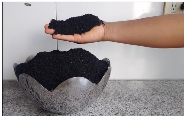
Figura 5. Caucho molido procedente de neumático
