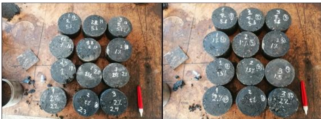
Figura 8. Especímenes con caucho al 1%, 1.5% y 2%
