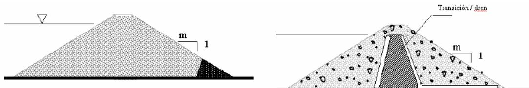
Fig. 3.10 Tipos de presas flexibles.
