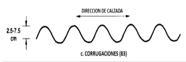
Figura N°37: Detalle corrugaciones URCI
