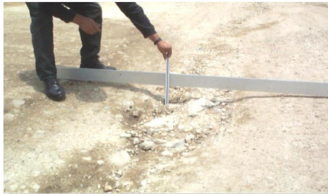
Figura N°26: Gravedad 3: profundidad \geq 10 cm
