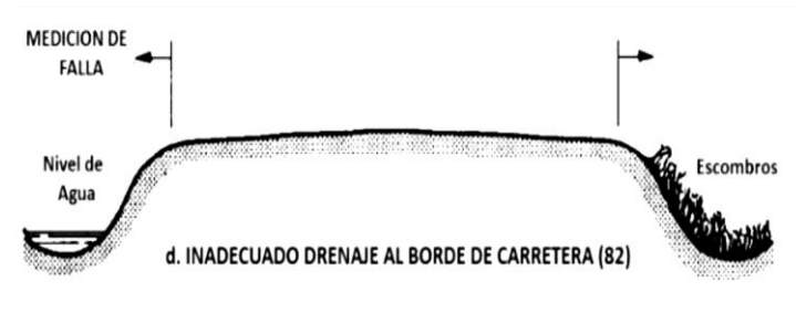
Figura N°36: Detalle drenaje inadecuado URCI
