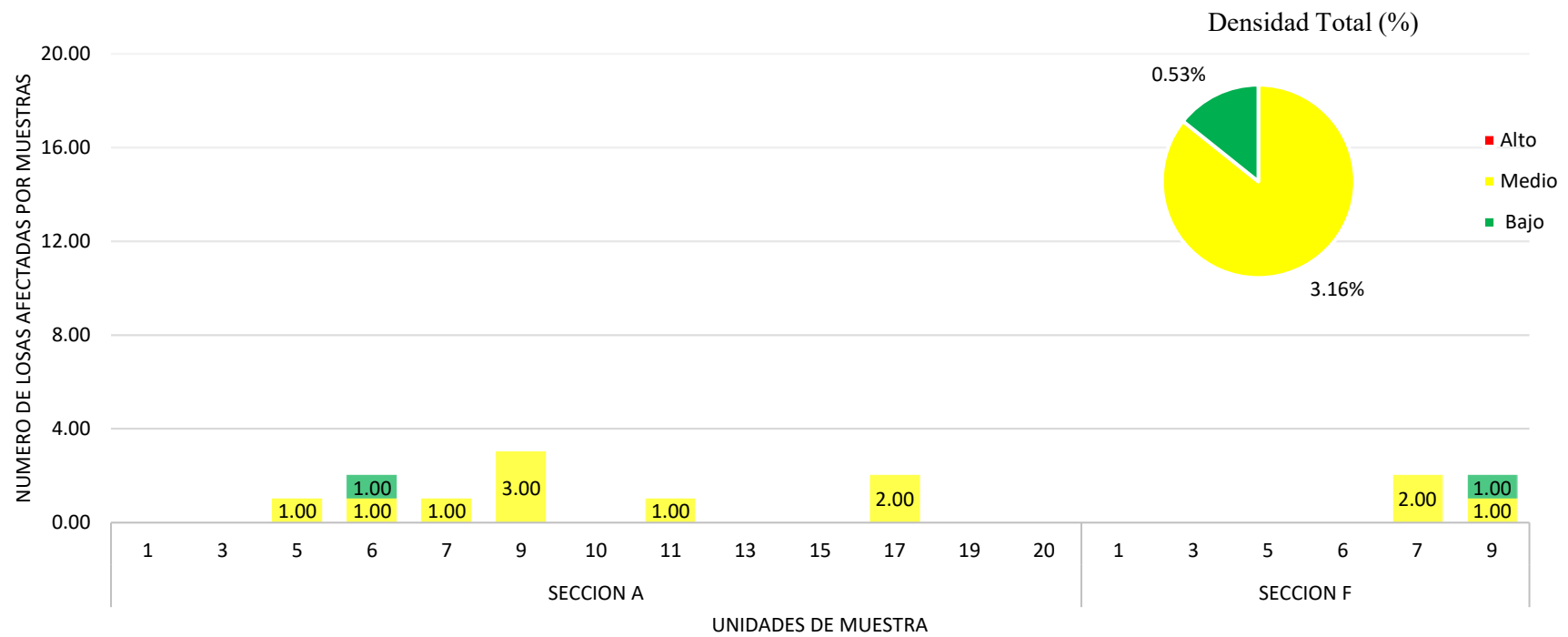
Figura N° 30. Número de losas con parches grandes según su severidad, por unidad de muestra inspeccionada.
