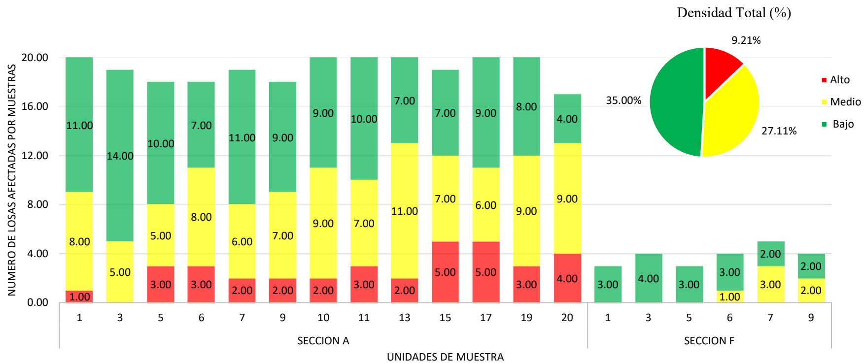
Figura N° 28. Número de losas con daño en sello de la junta según su severidad, por unidad de muestra inspeccionada.
