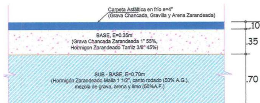
Figura N° 44. Estructura del pavimento flexible Fuente: Extraído de expediente técnico “Parchado, sellado y señalización horizontal del área de movimiento de Aeronaves del Aeropuerto de Jaén”
