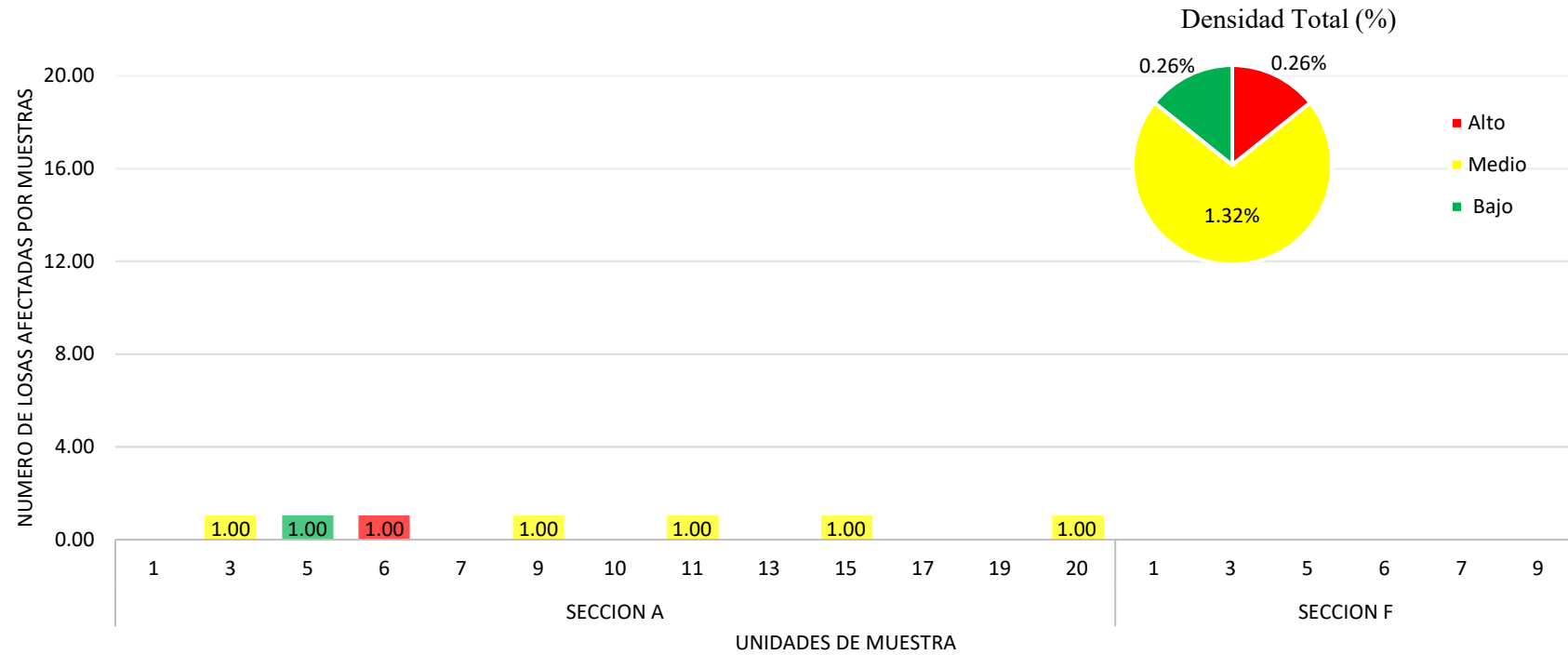
Figura N° 26. Número de losas con ruptura de esquinas y su severidad, por unidad de muestra inspeccionada.
