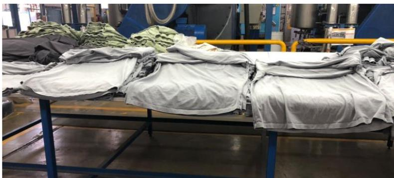
Figura 44. Prenda con defecto de mancha de soleado
