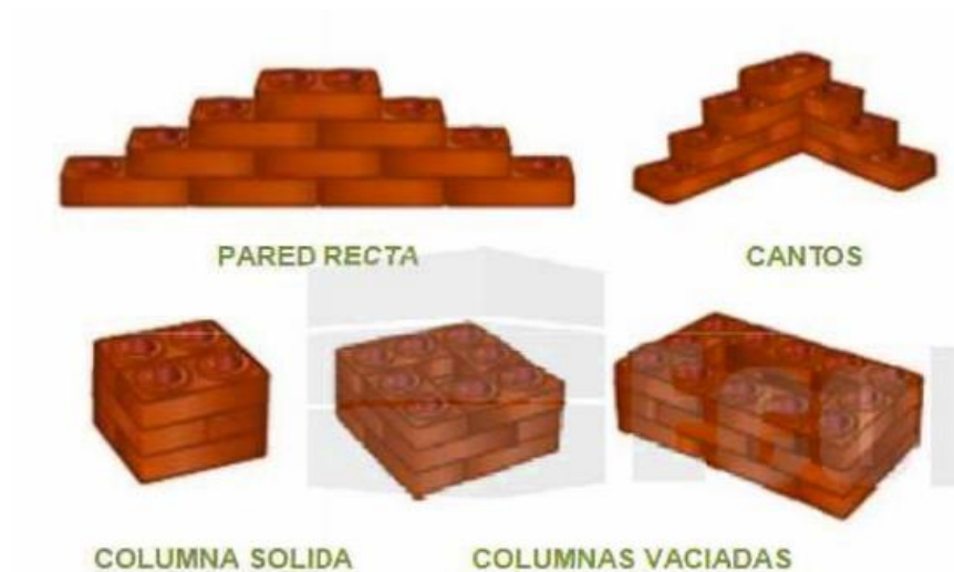
Figura 51. Columna – Muro Ecoladrillo
