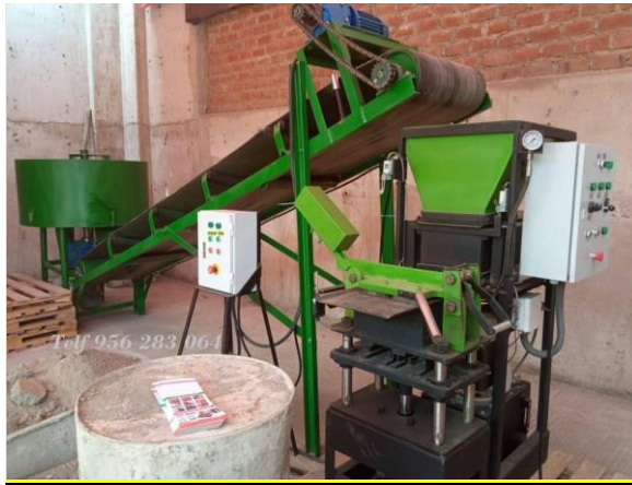
Figura N° 55. Proceso de elaboración del ecoladrillo
