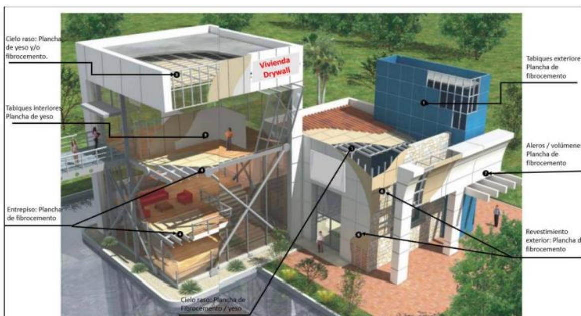
Figura N° 7. Componentes de una vivienda de Drywall.
