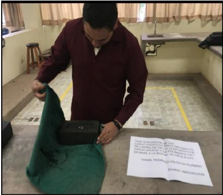
Figura 67 : Secado del ladrillo
