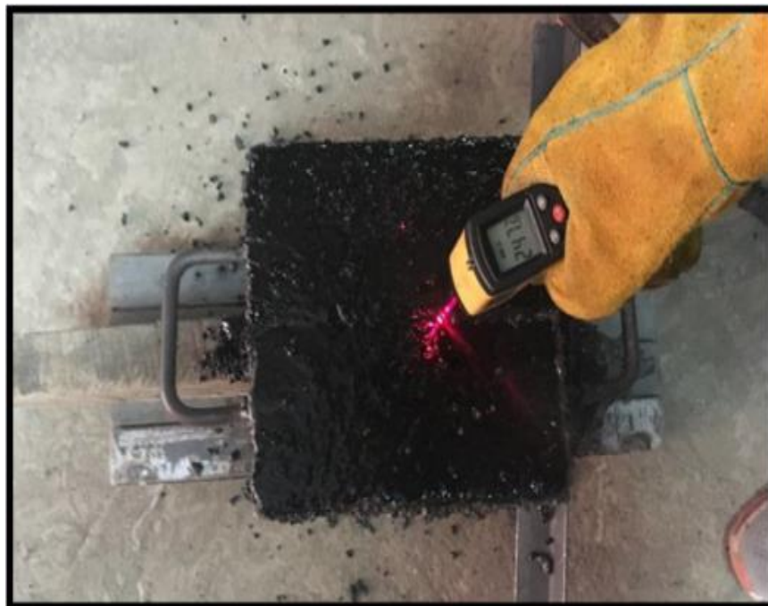
Figura 56 : Medición de temperatura antes de desmoldar
