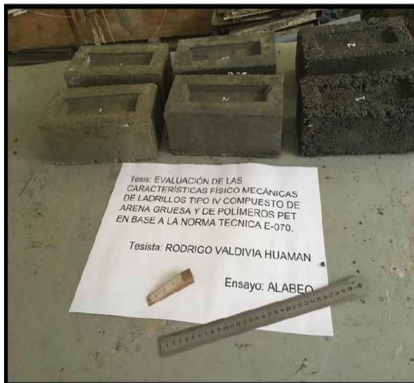
Figura 61 : Ensayo de alabeo
