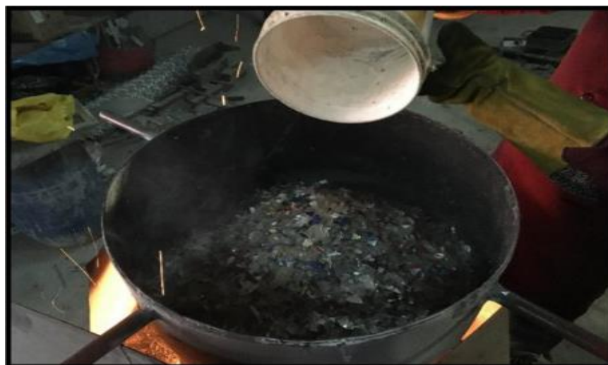
Figura 51 : Vertido del PET para la mezcla
