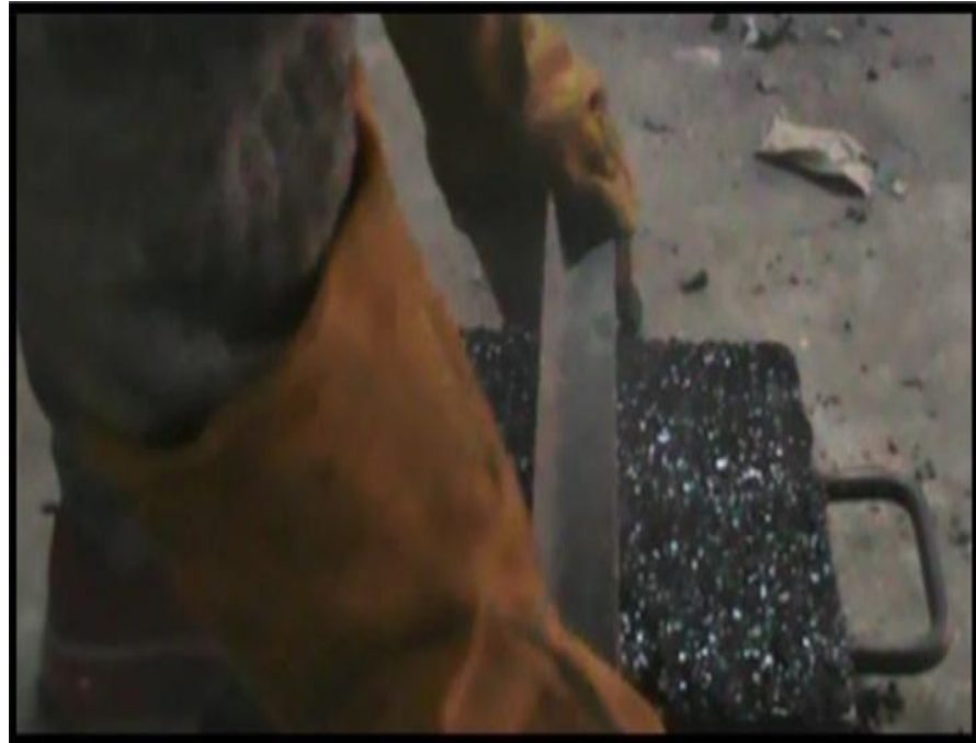
Figura 54 : Enrase del PET y arena gruesa en el molde
