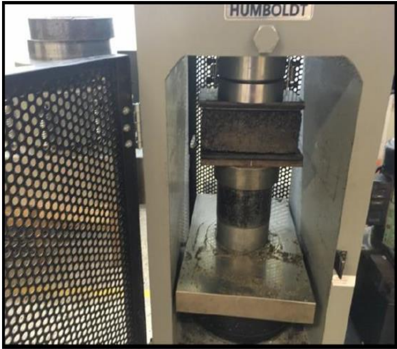
Figura 70 : Prueba de resistencia a compresión de ladrillo PET
