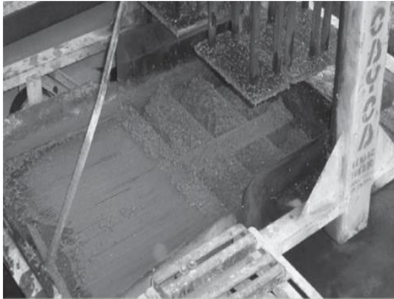
Figura 14 : Máquina que compacta la mezcla
