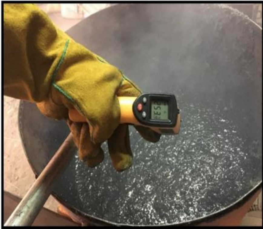
Figura 52 : Medición de temperatura previa al moldeado
