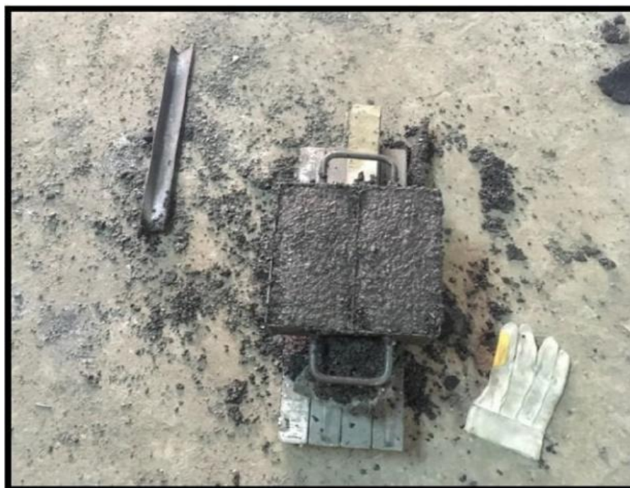
Figura 57 : Ladrillo PET frío antes de desmoldar
