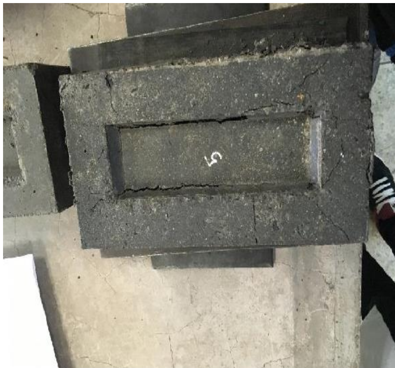
Figura 71 : Ladrillo de PET 80% y arena gruesa 20%
