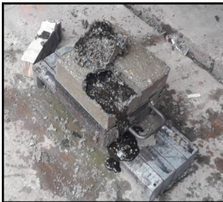
Figura 58 : Ladrillo PET desmoldado antes de tiempo
