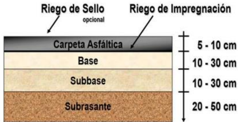
Figura 1 - Sección Transversal de una Vía.
