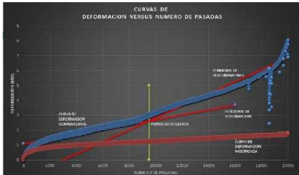
Figura N° 4: Deformación vs Número de Pasadas mezclas
