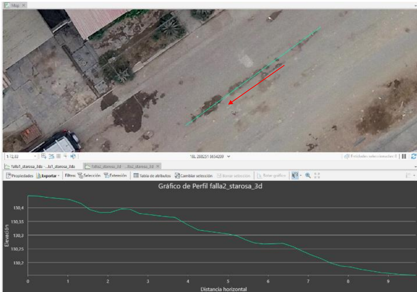
Figura 91. Perfil de la zona del pavimento donde se encuentra la falla. Fuente: Elaboración propia usando ArcgisPro ®.
