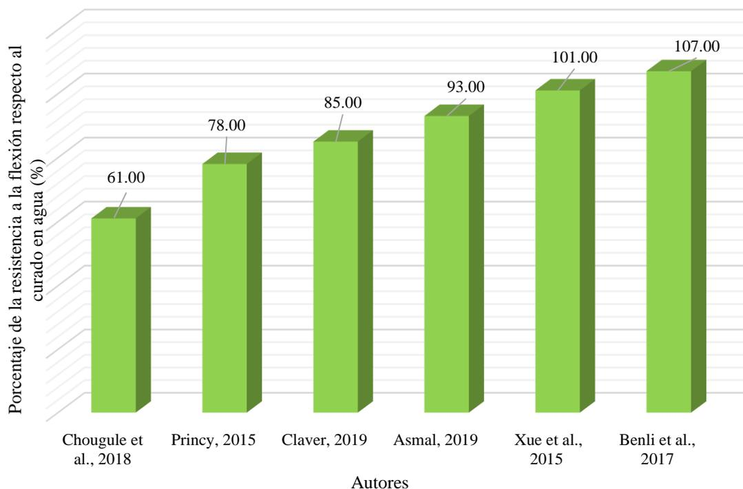
Figura 68. Resultados de los porcentajes de la resistencia a la flexión cuando se aplica curadores químicos, respecto al curado en agua a los 28 días para cada uno de los autores.
