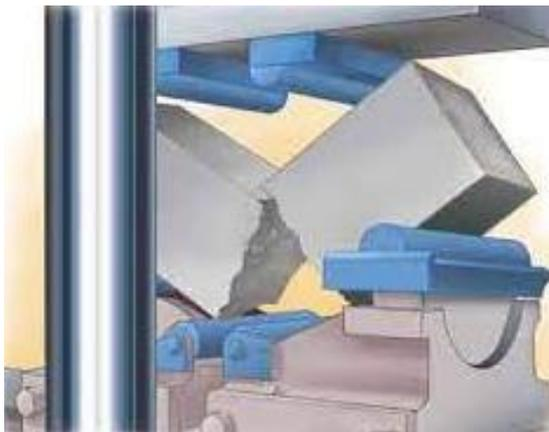
Figura 8. Ensayo de resistencia a la flexión
