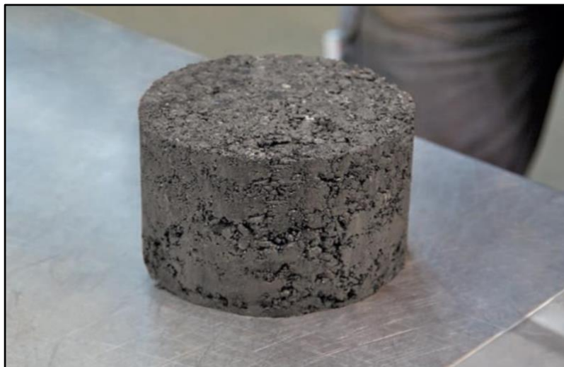
Figura N°14: Probeta de Asfalto Espumado Fuente: Adaptado de Ing. José Luis Martucci (2018)
