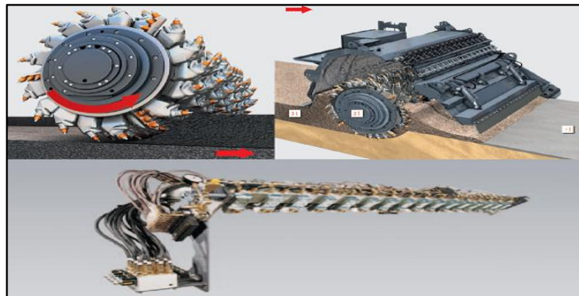
Figura N°44: Picas, tablero de presión y distribución de boquillas en la recicladora Fuente: Elaboración Propia
