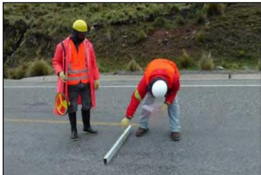
Figura N°29: Levantamiento de fallas 2 en la carpeta de rodadura Fuente: Adaptado de Thenoux (2010)
