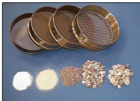
Figura 5. Tamices típicos y resultados del análisis granulométrico por tamizado
