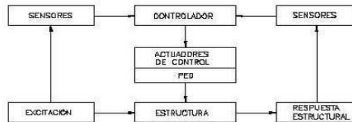
Figura 10: sistema de control semiactivo
