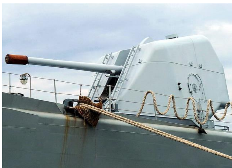
Figura N° 24: Montaje 127/54 mm de la Fragata Misilera Clase Carbajal / Aguirre Fuente: Revista Marina de Guerra del Perú, 2018.
