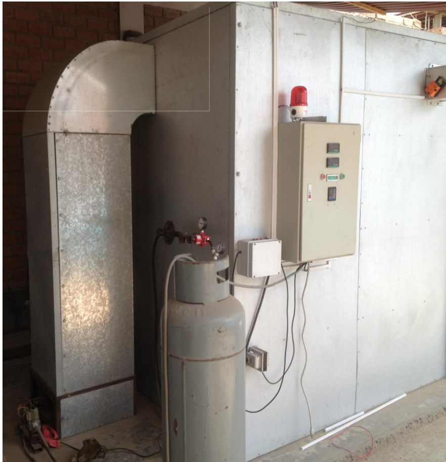
Figura 2.29: Sistema final de la cámara de secado.
