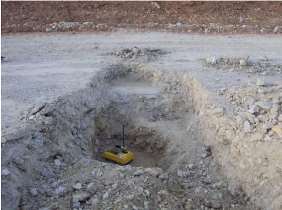
Fotografía 6: Compactación del material de desmonte de mina de Chipmo
