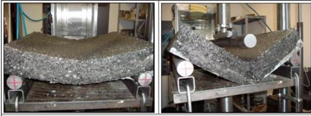
Figura 0.24: Las muestras después de la rotura
