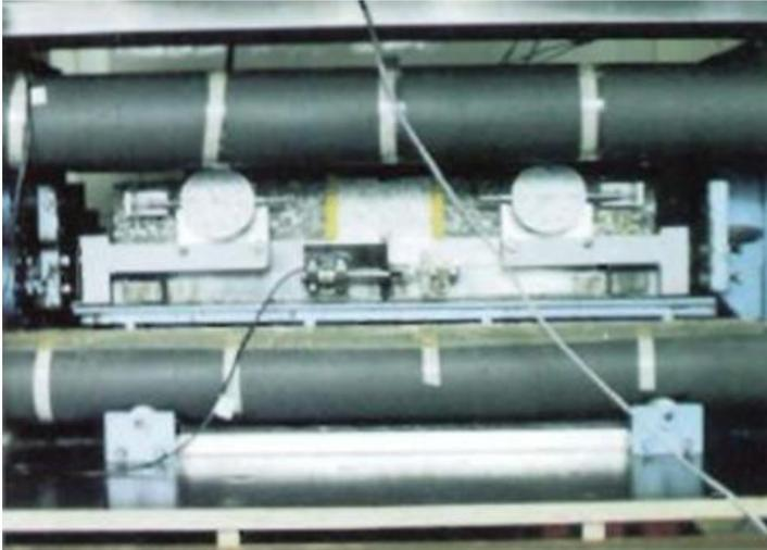
Figura 0.68: Prueba de Agrietamiento Térmico en Intercapa antifisuras, realizada por BRRC
