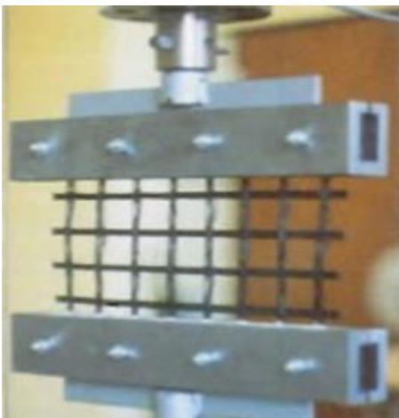
Figura 0.70: Producto de interfaz en una prueba de tracción
