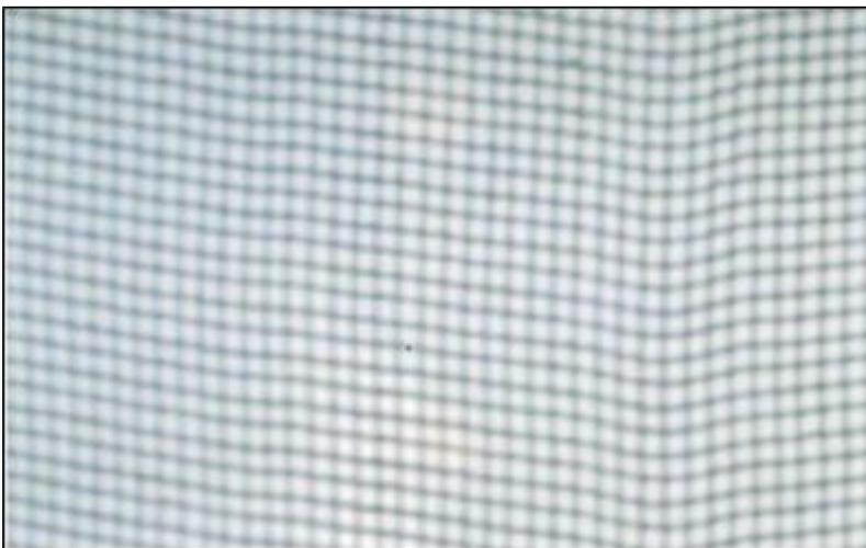
Figura 0.65: Geotextil tejido
