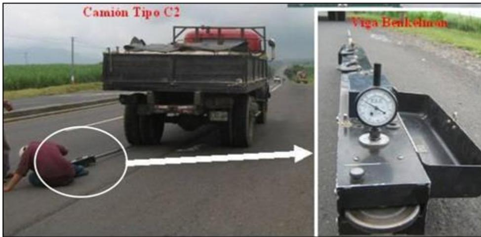
Figura 0.26: Colocación de la Viga Benkelman. Posición inicial y final
