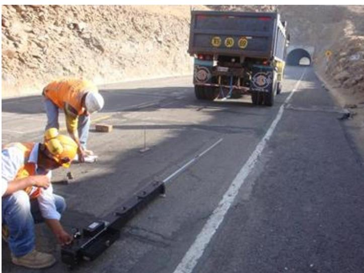
Figura 0.14: Medición con la Viga Benkelman
