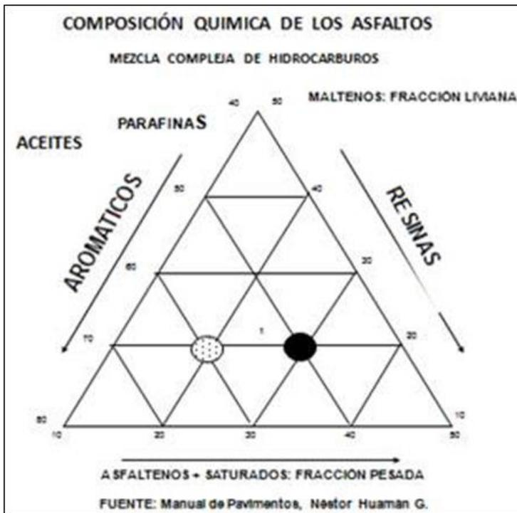
Figura 0.4: Representación esquemática de la composición química del asfalto
