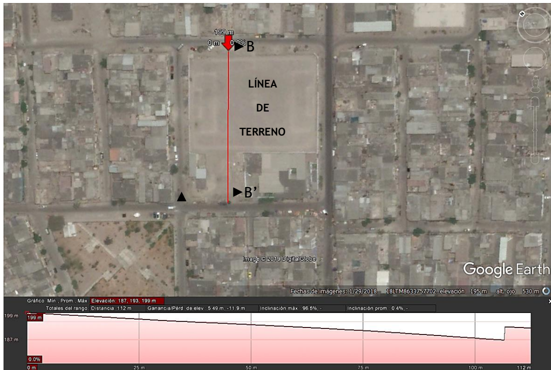
Figura 49. Corte longitudinal de pendiente del terreno
