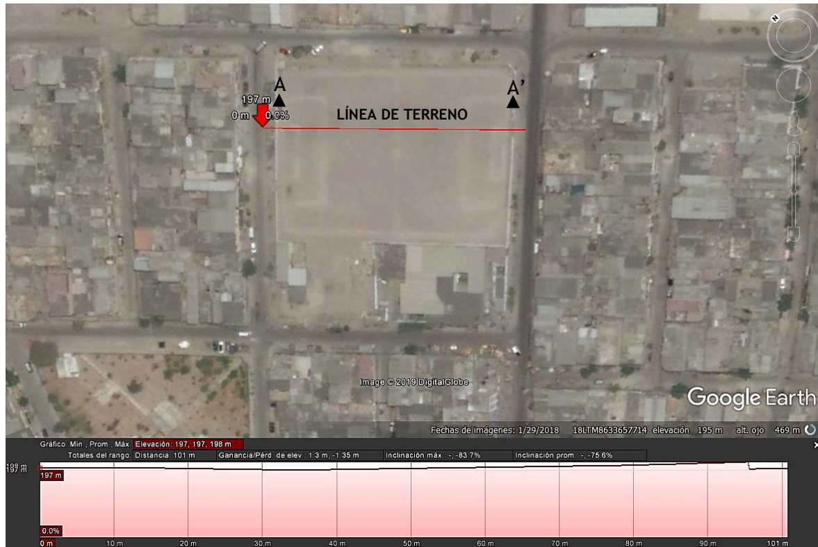
Figura 48. Corte transversal de pendiente del terreno
