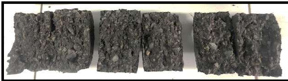
Figura 19: Ensayo de Lottman modificado en condición húmeda.
