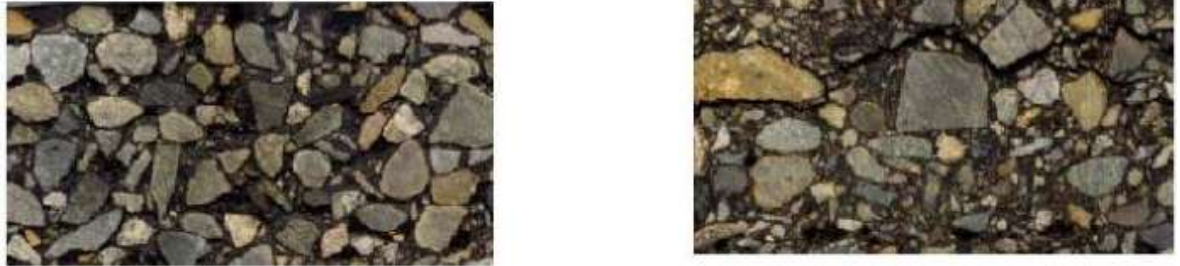
Figura 7: Comparación entre una mezcla SMA y un Superpave
