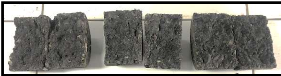
Figura 18: Ensayo de Lottman modificado en condición seca.
