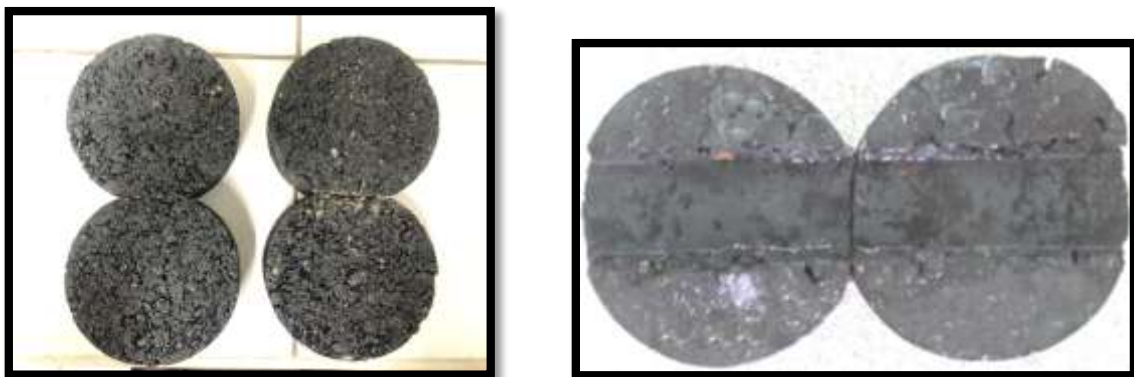
Figura 23: resultado del ahuellamiento de la rueda cargada a la mezcla asfáltica SMA con fibra y ceniza del bagazo de caña de azúcar.
